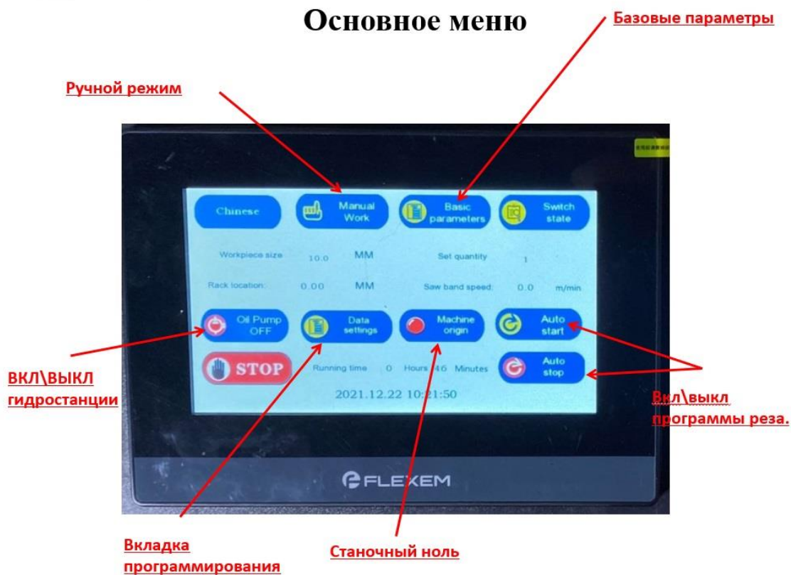
Рисунок 3. Основное меню ЧПУ ленточнопильного станка Metal Master MSK-400
