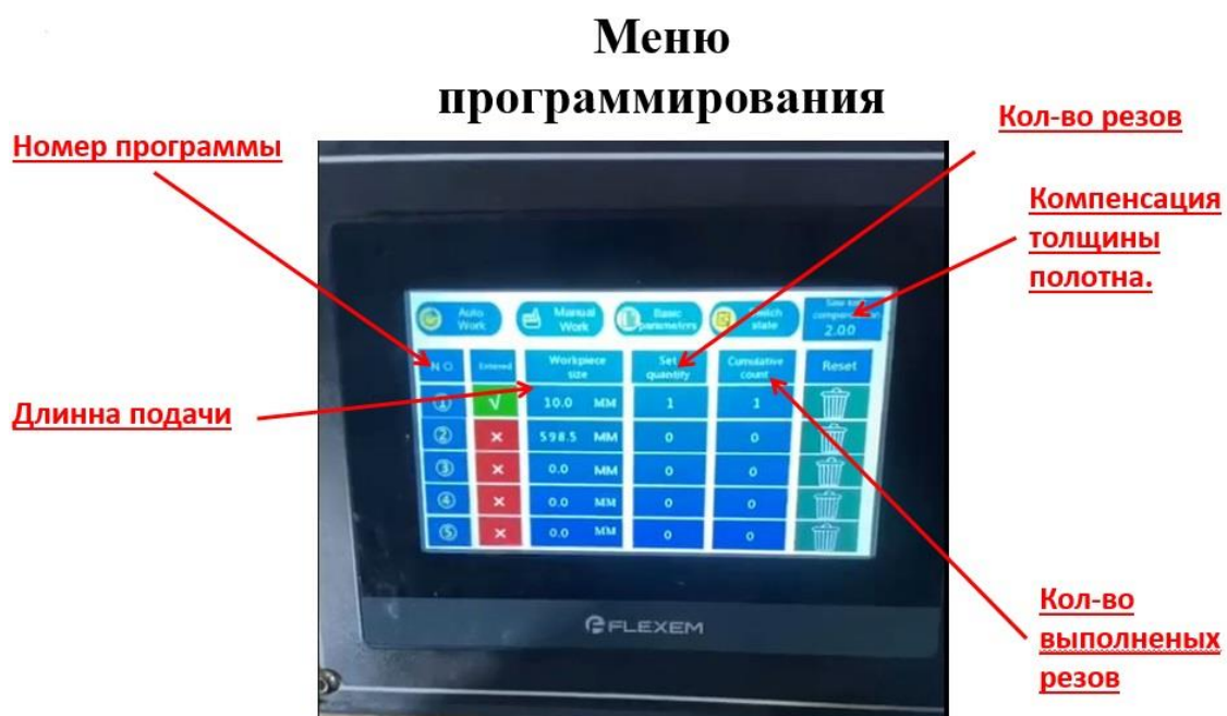
Рисунок 4. Меню программирования ленточнопильного станка Metal Master MSK-400
